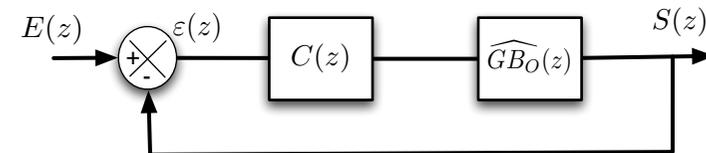
Schéma équivalent aux instants d'échantillonnage
